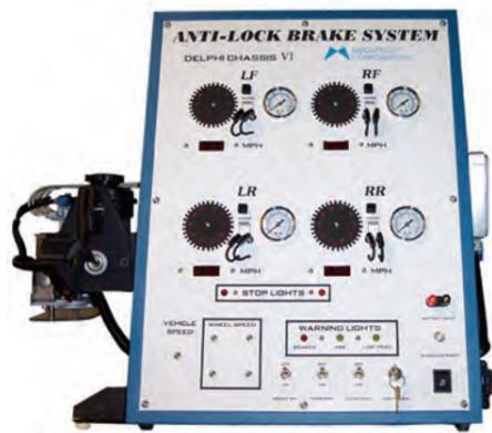
El sistema de frenos ABS Megatechin incorpora componentes vivos y líneas hidráulicas, y es un auto-contenido de pleno funcionamiento del sistema de frenado fabricado con componentes auténticos de automoción. El Chasis de Delphi VI ofrece una amplia gama de manómetros que muestran una presión de contacto delanteros y traseros y la presión individual en cada rueda.
