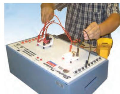
Este es el programa idéntico al usado por Ford Motor Company en todo el mundo en sus centros de capacitación. Cubren los conceptos básicos de electricidad utilizando placas individuales que contienen piezas reales del automóvil para construir circuitos diferentes.
