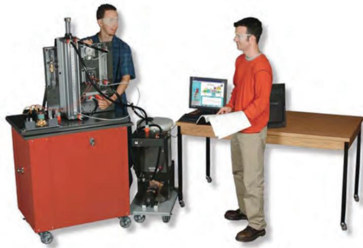
El Entrenador de Procesos de Flujo, Nivel, Presión y Temperatura es un banco de trabajo, completamente modular, y móvil, diseñado para familiarizar a los estudiantes con los fundamentos de la Instrumentación y Control de Procesos.
